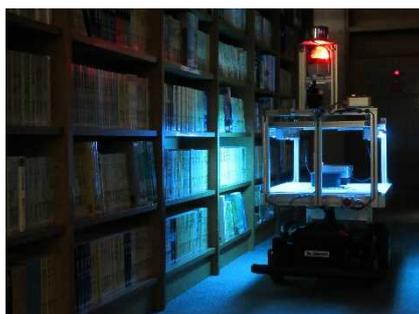
紫外線照射自動巡回ロボットによる除菌
