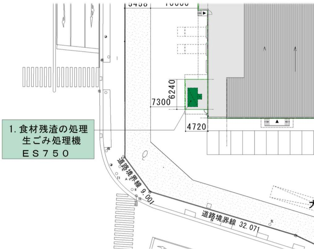
学校での食べ残し等の処理は粉碎し水切りすることでゴミの量を1/3から1/5程度に減量します。調理の過程で出る野菜くずなども合わせて、バクテリアによる分解を行う生ごみ処理機を用いて処分します。
