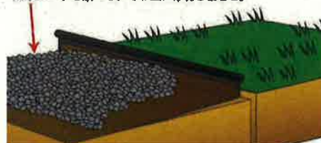
芝舗装と砂利舗装の見切り施工例
