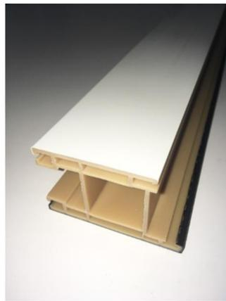
竹CNF含有塩ビコンジット押出成形品
