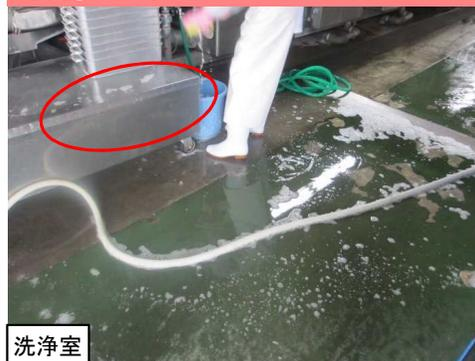
写真②C ドライシステムに非対応のシンク
