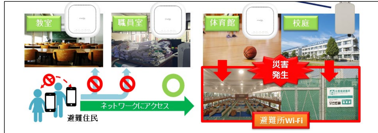
学校をモデルとした災害時用避難所 Wi-Fi のシステム構築例
