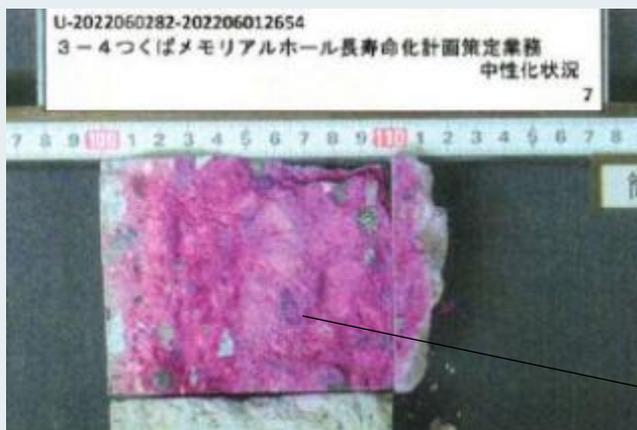
◎コンクリートの表面から中性化の進んだ距離(中性化の深さ)を測定する。
