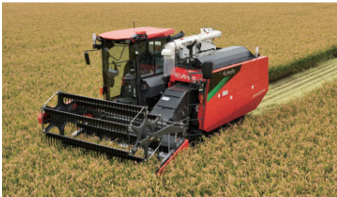
無人ロボットコンバインが稲を収穫する様子
