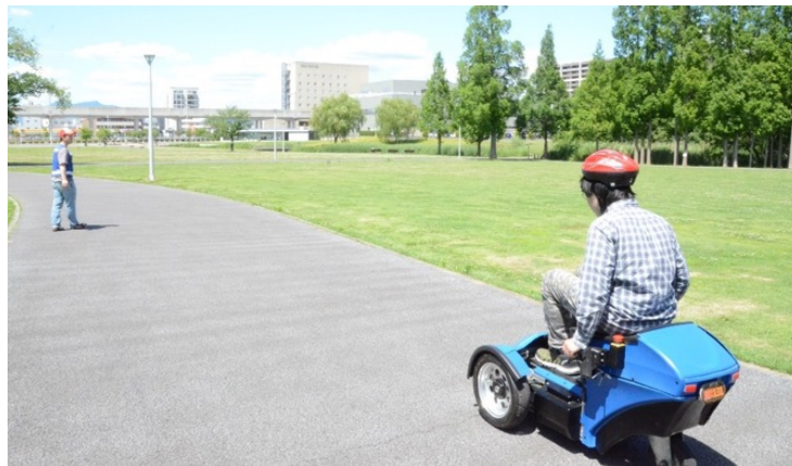
図1 手動走行での走行安定性の検証及び磁気情報の取得の様子
