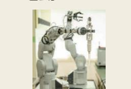
外部制御で容量設定・吸引・吐出・チップ排出までできるピペットです。コントローラー部からパソコンやPLCを繋ぎ設定・制御でき、手動やフットスイッチでも操作可能です。
