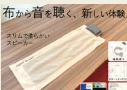
厚さ2mmのシート状のスピーカーです。外見および感触は一般的な布と同様であり、薄く柔軟で折り畳むことやロール状に巻くことができます。
