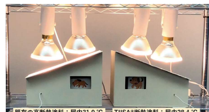
既存の高断熱塗料: 屋内31.9℃ TIISA® 断熱塗料: 屋内28.4℃
