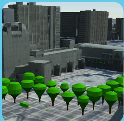
建物や樹木が多い場所では、衛星からの信号が建物で跳ね返ったり樹木にぶつかったりして、正確な位置が分からなくなることがあります。今回の実証実験では、つくば市の三次元地図を使うことで、衛星から直接届いているデータを選び、センサーを効率よく使えるようにして、自動運転に活用できるかどうかを確認します。
