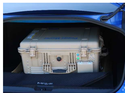
(搭載している給電設備)
