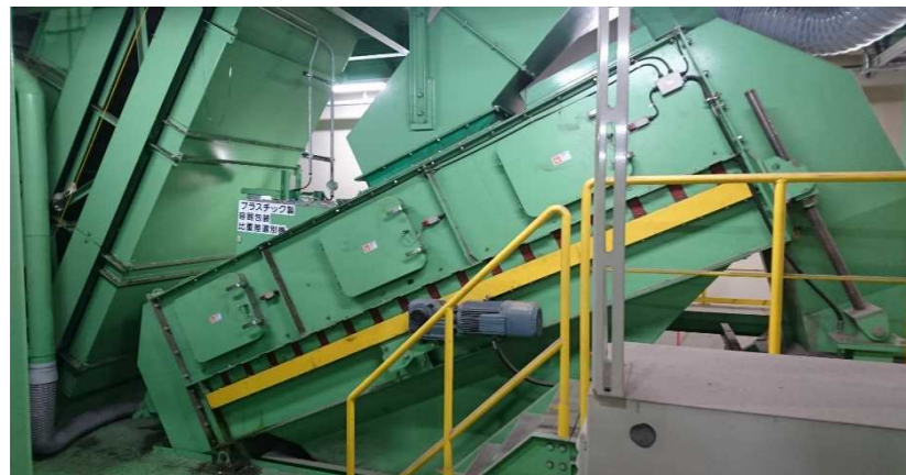
比重選別機 (風力により重いものと軽いものを選別し、手選別をしやすいとする。)
