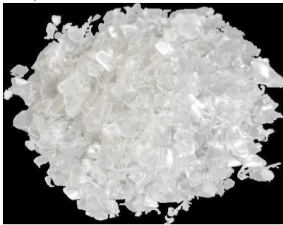
再生フレーク（PET破碎処理したもの）：半製品、食品市場のみならず、繊維をはじめ様々な用途に使用できる。
