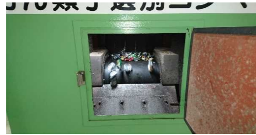
アルミ磁選機 (渦電流でアルミ缶を選別)
