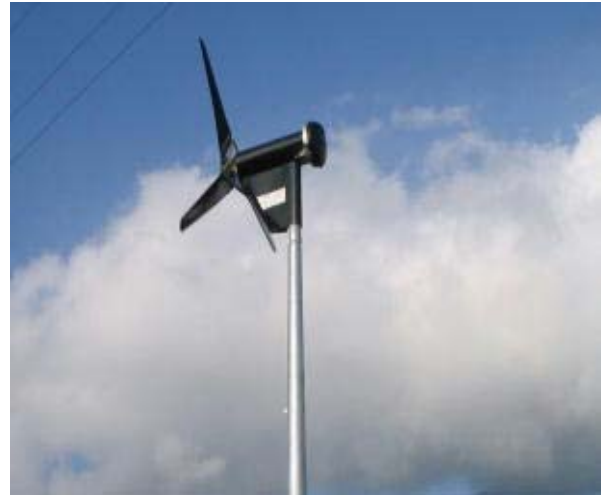
風力発電機 (6 kW)
