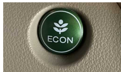
エコドライブスイッチ（例：上写真）をONにすると、車の制御が変わってゆっくり発進しやすくなります。
