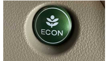
エコドライブスイッチ(例:上写真)をONにすると、車の制御が変わってゆっくり発進しやすくなります。
