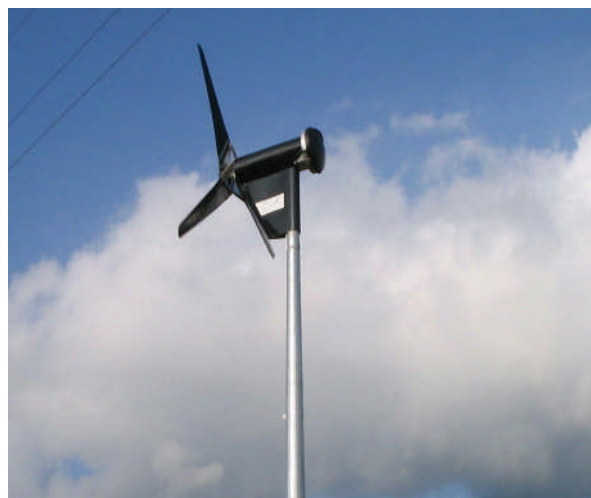
風力発電機 (6 kW)
