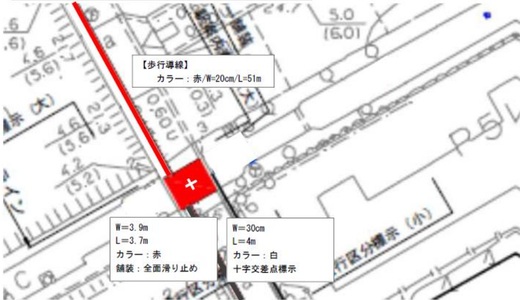
5-1135号線カラー舗装 / 歩行導線 / 十字交差点標示
