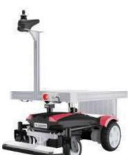
誰にでも簡単に使える運搬ロボット。サウザースタンダードE2、サウザージャイアントE2、サウザーベーシックの3機種。すべての機種に、前方の人や物に追従する「自動追従機能」を搭載しています。
