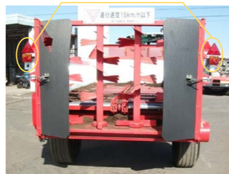
後部反射器及び灯火器類の設置例
