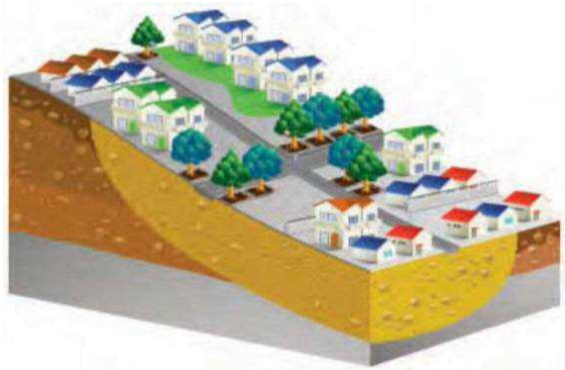
谷埋め型盛土
