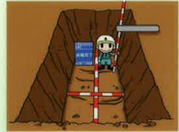
③ 床掘完了 L=△△△ W=△△△ H=△△△
