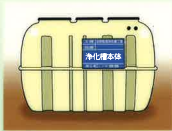
⑨ 浄化槽本体 ※メーカー、形式、人槽等が槽本体に書かれている場合には、これらがわかるように写す。
