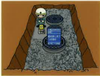
⑬ 埋め戻し完了、つき固め
