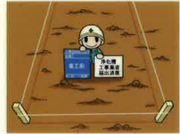
① 着工前 浄化槽設備士監督 ※背景に工事を行う場所の周辺状況を写す
