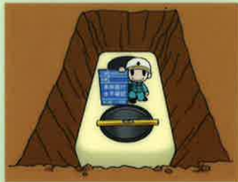
⑩ 本体据付、水平確認
