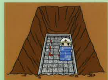
⑥ 基礎コンクリート 型枠、配筋状況鉄筋 D=△△ △=△△△
