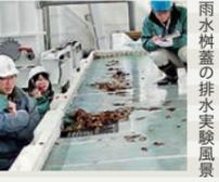
雨水排水の排水実験風景
