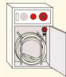
屋内消火栓設備
