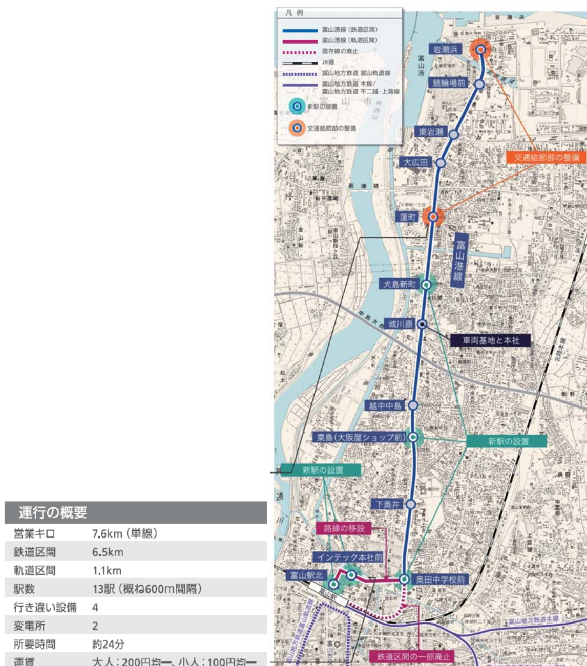
図 17.富山ライトレール（ポートラム）
